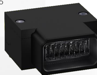
Illustration 3: ODU BACKPLANE selon le standard VITA 96.5 relie jusqu'à 96 fibres optiques.
